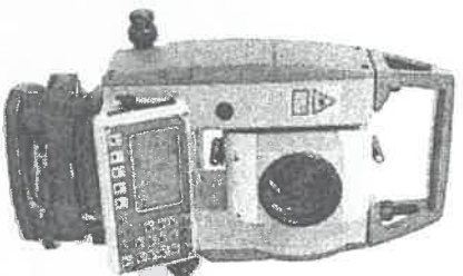
Imagen 2. Estación Total Spectra Focus 2
